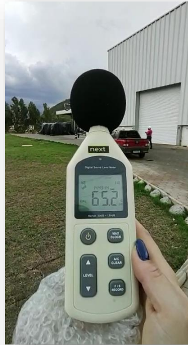
Figura 15. Medição de ruídos realizado na Unidade em Rifaina.
